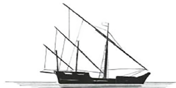
Imagem 1 - Configuração da Caravela portuguesa dos três mastros do final do século XV mostrando que o mastro grande permanece a meio da quilha
